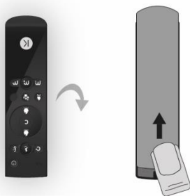
Figuur 3: Batterij plaatsen
