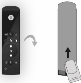
Figuur 23: batterij plaatsen
