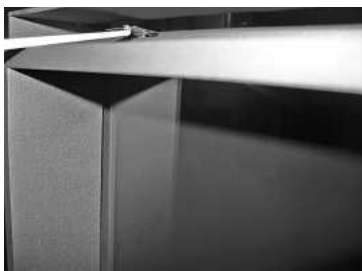
- Trek met de haak, middenboven, de dunne, metalen veer-strip van het nokje van het frame af.
