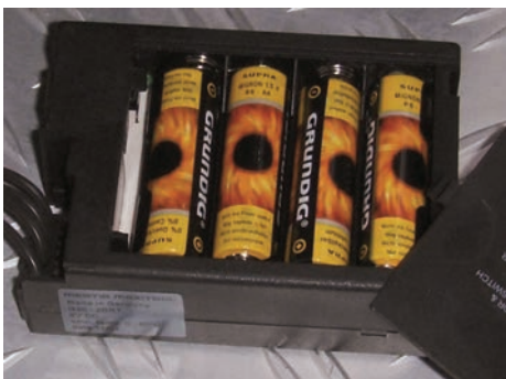
Remplacement des piles du récepteur
