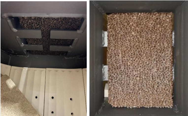
Montage van katalysator boven de kogelvanger achter het rookschot voor M, Maestro, QM40 ecoline
